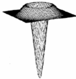
Fig. 16 - Definizione di Laplacian of Gaussian. La componente G effettua lo smoothing, la componente differenziale \nabla^2 realizza la rilevazione degli edge.
