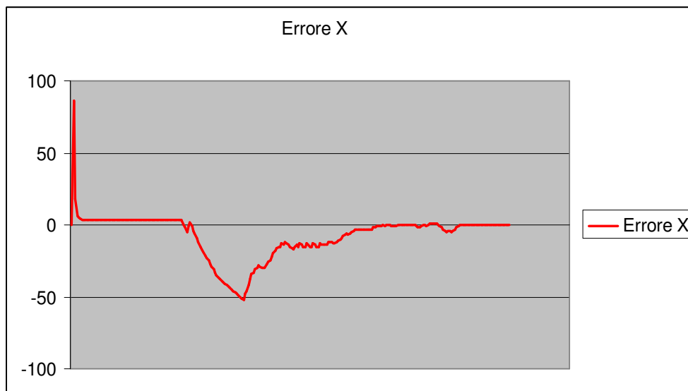
Fig. 56 - Andamento dell'errore nella stima della coordinata X dello stato del sistema (in mm) rispetto al passo temporale (rappresentato sull'asse delle ascisse nel grafico).
