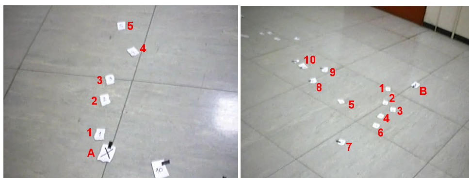
Fig. 61 – Particolari dei marker artificiali distribuiti sul pavimento. Nella foto di sinistra si può vedere l'allontanarsi del robot al passaggio nel punto A, già nel giro numero 5 la posizione è distante oltre 60 centimetri. Nella foto di destra si possono invece vedere dall'alto i diversi passaggi del robot nel punto B.
