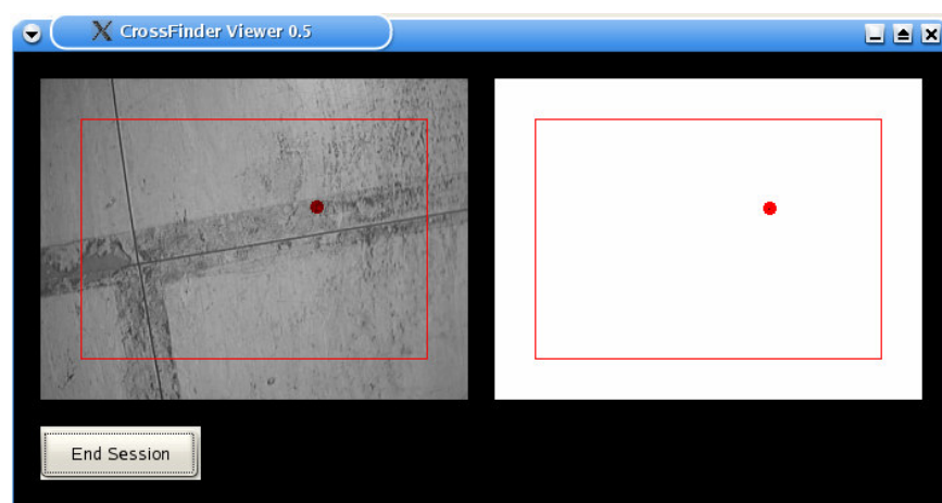
Fig. 25 - Output dell'applicazione di test, in condizioni di pavimento molto sporco con luce naturale. Si vedono chiaramente diffusi residui di colla lungo le fughe del pattern, e aree opache dovute ad usura e a sporcizia. Il punto rosso identifica la posizione del corner.
