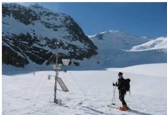
La loro struttura è basata su microcontrollore e sono connessi in LOS (Line of Sight) con un vicino rifugio di montagna, dove è posizionato un Access Point (per IoT).
