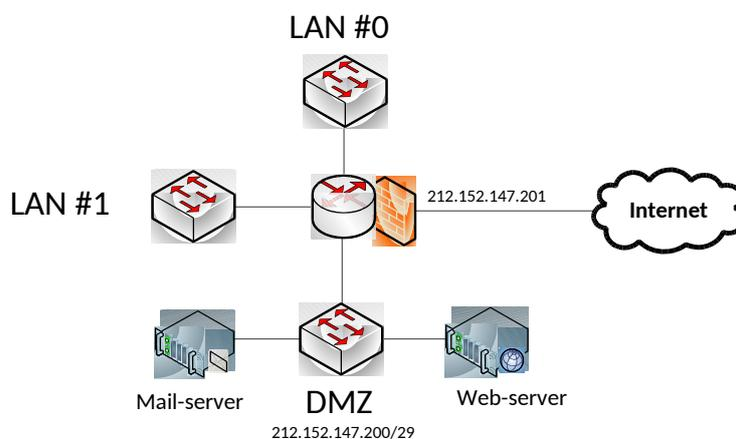
Dopo avere ipotizzato un adeguato schema di indirizzamento IPv4 definire le regole di firewalling da applicare alle varie porte del router per garantire la sicurezza delle reti DMZ/LAN ed il filtraggio degli accessi.
